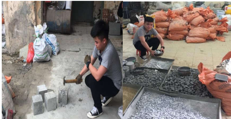
Hình 1. Xử lý cốt liệu bê tông tái chế
